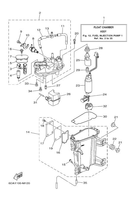
FIG. 12 FUEL INJECTION PUMP 1
