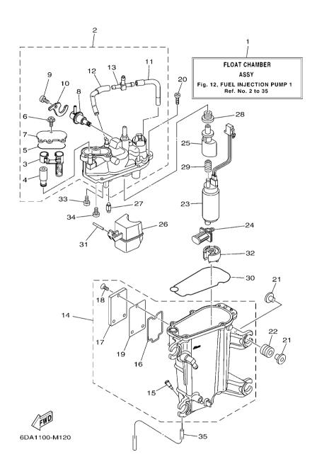
FIG. 12 FUEL INJECTION PUMP 1
